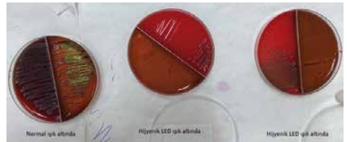
Resim 2: Normal ışık ve HLL ışığın 24 saatlik sürede petri kutularına 0,5 McFarland standardında inokule edilmiş E.coli suşlarına olan etkisi
